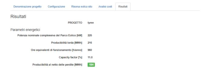
Figura 32: Dimensionamento dell'impianto eolico
