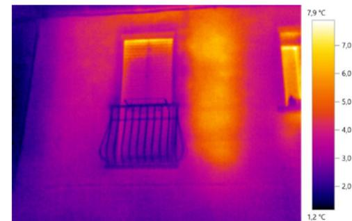
Nelle quattro termoanalisi sottostanti possiamo notare con evidenza la distribuzione disomogenea del calore lungo la maglia di mattoni del soffitto, così come gli spifferi provenienti dalla finestra. Parlando di soffi d'aria, rileviamo, anche in Sardegna, come l'infisso non blocchi l'aria fredda esterna che entra attraverso i pertugi di un infisso che non isola perfettamente ambiente interno da ambiente esterno.
