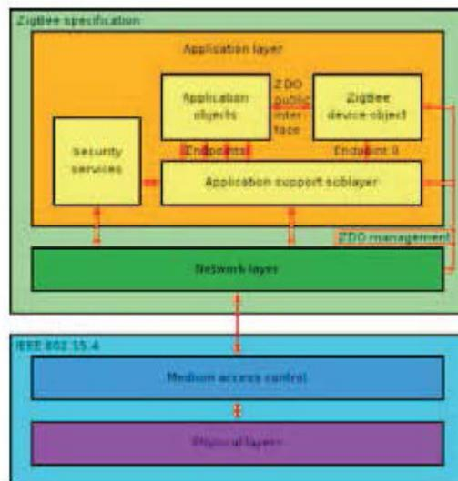
I protocolli ZigBee con i vari profili di utilizzo sono progettati per l'uso in applicazioni embedded che richiedano un basso transfer rate e bassi consumi. L'obiettivo attuale di ZigBee è di definire una Wireless mesh network non mirata, economica e autogestita che possa essere utilizzata per scopi quali il controllo industriale, le reti di
