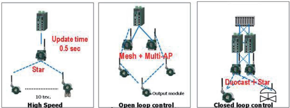
Altre caratteristiche della tecnologia ISA100.11 sono la comunicazione a lunga distanza (dai 600 m ai 1500 m con antenna 6DBi - non approvata in EC), la customizzazione delle reti che porta dei vantaggi in termini di risparmio energetico, sviluppo delle applicazioni di controllo anche critiche, ridondanza sensori definita, definizione delle velocità di comunicazione che può arrivare a 0,5 secondi.
