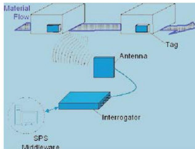
Il tipo di trasmissione dei dati tra lettore e transponder differisce a seconda delle caratteristiche del tag impiegato e si distingue in due tipologie di trasmissione: tramite accoppiamento elettromagnetico oppure induttivo. Per quanto riguarda la catalogazione in base alla frequenza d'impiego, si definiscono quattro differenti famiglie:
