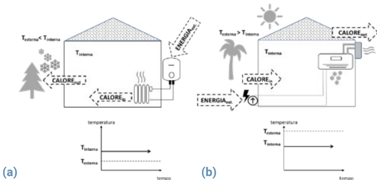
Come schematizzato in Fig. 2, gli scambi di calore tra edificio e ambiente esterno necessari per mantenere la temperatura interna costante (e diversa da quella ambientale) sono resi possibili grazie a impianti termici (caldaia, condizionatore) che necessitano di energia per poter funzionare.
